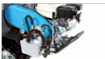
Distributore a leva per comando ribaltamento idraulico.
