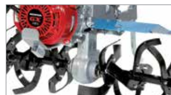
Trasmissione ad ingranaggi in bagno d'olio, resistente e con bassissima manutenzione.
