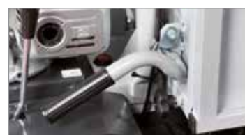
Ribalramento manuale con sistema di bloccaggio automatico.
