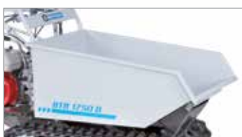
Pianale di carico di tipo dumper con controltaio per angolo di ribaltamento a 60°.
