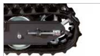
Cingoli in gomma dura di 180 mm di larghezza: garantiscono un'ottima aderenza su ogni tipo di terreno.
