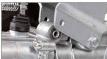
Manillar montado sobre soportes antivibración.
