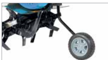
Rueda trasera para transportar la máquina.
