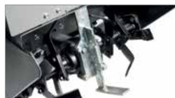
Regulación de la profundidad de la fresa para utilizarla en cualquier tipo de terreno.
