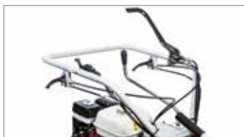
Dirección con desbloques y frenos de mando independiente.
