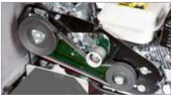
Embrague de correa con desacoplamiento automático al soltar la palanca de mando.
