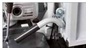
Basculamiento manual con sistema de bloqueo automático.
