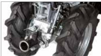
Attacco rapido QuickFit che consente all'operatore di cambiare le attrezzature senza l'utilizzo di chiavi.
