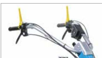
Frizioni di sterzo indipendenti sulle ruote motrici con bloccaggio delle ruote che permettono di manovrare la macchina con estrema facilità.
