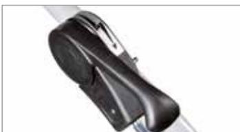
Pratico inversore di marcia, che permette di passare velocemente alla retromarcia da qualsiasi velocità: rende la macchina maneggevole anche con la fresa e altri accessori.
