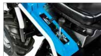
Comando di avanzamento tramite leva o con pedale, una soluzione di comfort ottimale in base all'area di lavoro.
