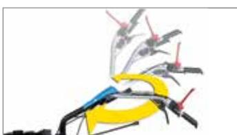
Stegole regolabili verticalmente ed orizzontalmente tramite una comoda leva a manubrio, permettono all'operatore di lavorare con una postura corretta.
