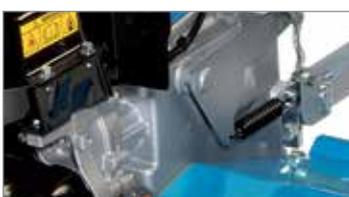
Trasmissione diretta ad ingranaggi sull'albero motore per estrema resistenza alle sollecitazioni.
