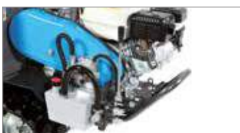
Distribuidor de palanca para mando del volteo hidráulico.
