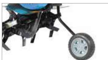
Rueda trasera para transportar la máquina.
