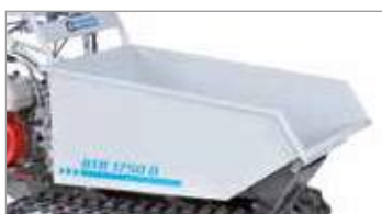
Plataforma de carga dumper con contrabastidor para un ángulo de basculamiento de 60°.
