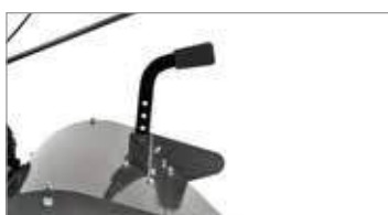
Fresa de 50 cm con regulador de profundidad.
