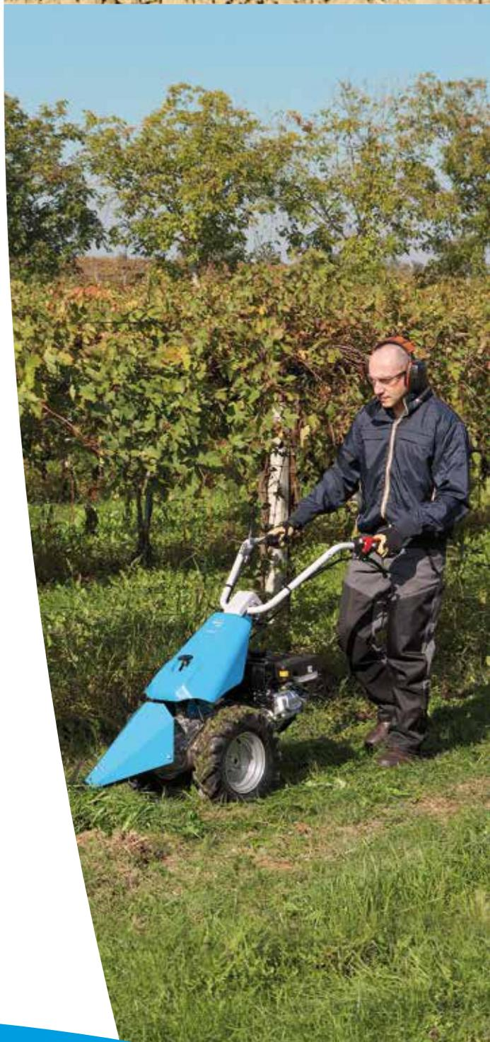
\* QuickFit: sistema di attacco rapido che consente all'operatore di cambiare le attrezzature (barre falcianti, frese, ...) senza l'utilizzo delle chiavi
